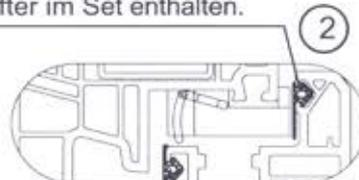
Dichtung 112.300 im Bereich des Falzlüfters
